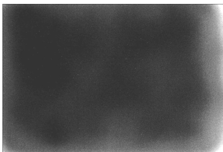
4.1. ábra. Digitális fényképezőgép által, hosszú expozíció során keltett termikus zaj. A kép jobb szélén jól látszik az erősítő által okozott melegedés hatása.
