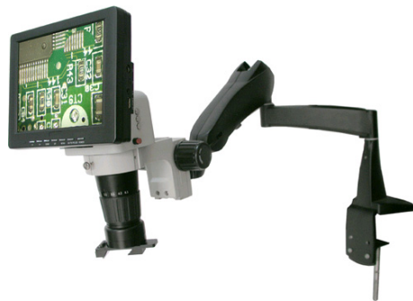
9.4. ábra. LCD panellel felszerelt ipari mikroszkóp. Az állítható kar könnyű hozzáférést tesz lehetővé kiterjedt objektumokhoz.
