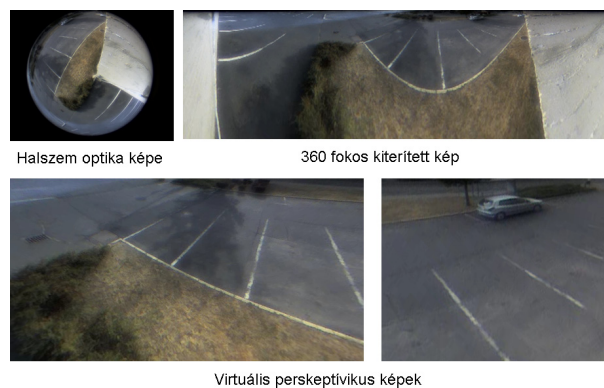
10.2. ábra. Halszem optikával rögzített panoráma kép és transzformált változatai
