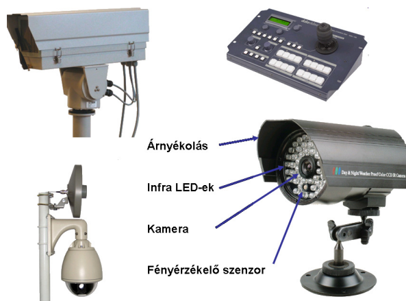
10.1. ábra. PTZ (Pan-Tilt-Zoom) kamera, PTZ irányító egység, dome kamerához rádiós kapcsolattal, infra megvilágítóval felszerelt kamera
