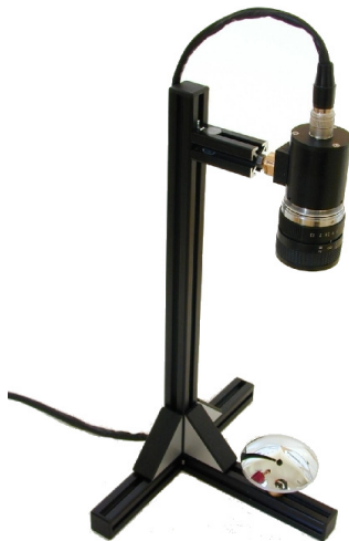
2.11. ábra. Viszonylag egyszerű eszközökkel (hagyományos kamera, tükör) is készíthető katadioptrikus panoráma kamera
